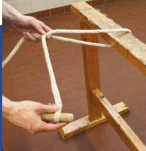
2. Forme eine Schlaufe und lege das Ende wieder von oben über den Balken.
